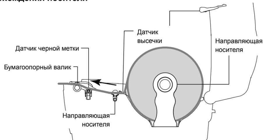
(7) Используя «Diagnostic Tool» (Программу диагностики), задайте тип датчика носителя и откалибруйте выбранный датчик. (Запустите «Diagnostic Tool» (Программу диагностики)). → Перейдите на вкладку «Printer Configuration» (Конфигурация принтера). → Нажмите кнопку Calibrate Sensor (Калибровка датчика). Для получения дополнительной информации см. краткое руководство по Утилите диагностики.
